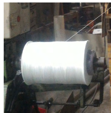
圖 1. 玻纖表面處理→玻纖 /PP 複合線→編織→定型熱壓
