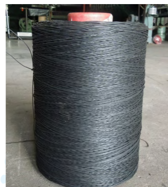
圖 1. 玻纖表面處理→玻纖 /PP 複合線→編織→定型熱壓
